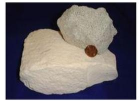
**Zeolithe** sind inerte Silikat Minerale mit hochporöser, schwammähnlicher Struktur und **riesiger Oberfläche**. Damit bilden sie optimale Siedlungsflächen für Kleinstlebewesen, wie Bakterien, auf der Oberfläche und auch im Inneren.
